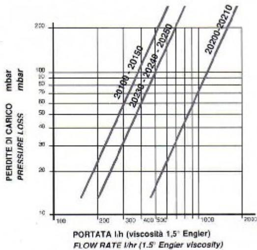
I collaudi dei nostri filtri vengono eseguiti con cartucce filtranti perfettamente pulite con grado di filtrazione di 100 µm.
